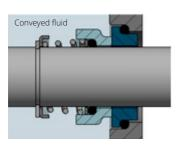
**DOUBLE-ACTING MECHANICAL SEAL (BACK TO BACK)**
